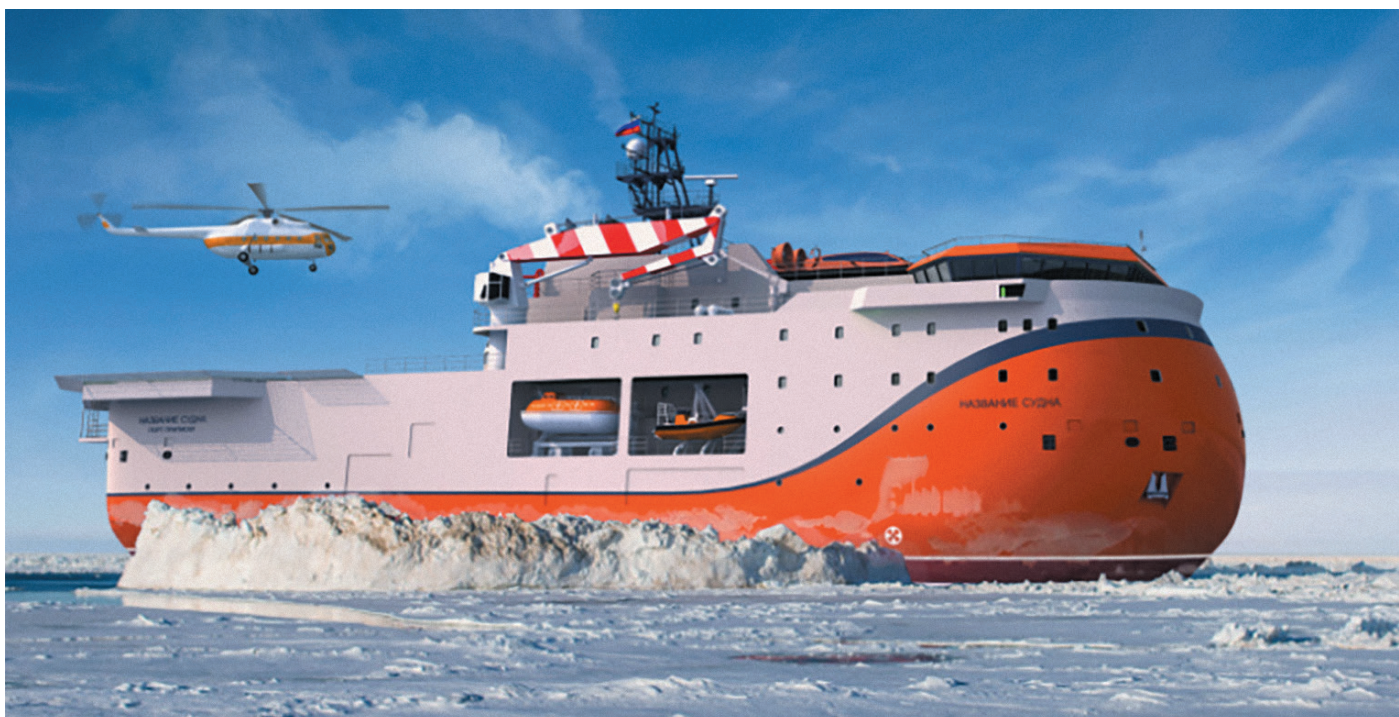
ЛСП «Северный полюс» имеет специальную форму, которая препятствует сжатию ее во льдах. Фото: визуализация проекта КБ «Вымпел» с сайта ААНИИ
